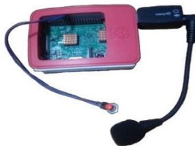
Fig. 5. Sistema Empotrado para tratamiento de señales de audio.
