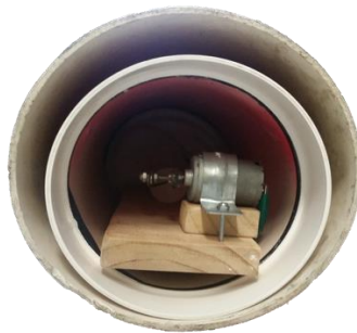
Fig. 9. Tanque de lastre conteniendo la cabina principal.
