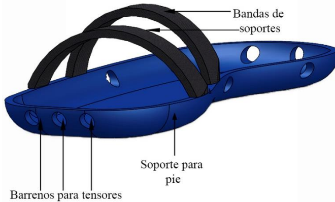
Fig. 2. Diseño de prototipo de base para pie con bandas de seguridad adaptables al paciente.
