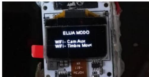
Fig. 9. Selección de modo de funcionamiento como camara auxiliar o como sensor de movimiento.
