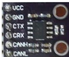
**Fig. 6.** Transceptor CAN MCP2551 superficial montado en una tarjeta para conexión al protoboard.
