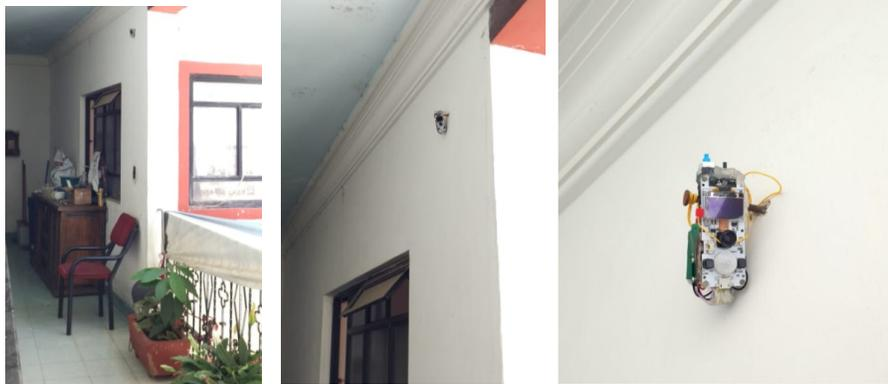
**Fig. 16.** Dispositivo montado provisionalmente apuntando a un pasillo durante las pruebas de funcionamiento.
