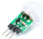
**Fig. 2.** Microsensor de movimiento PIR.
