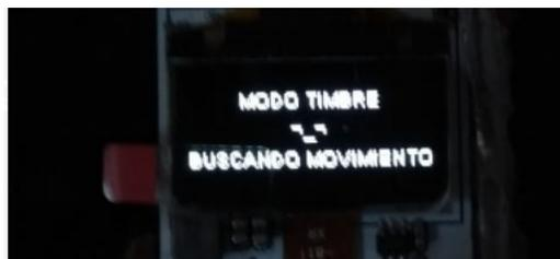
**Fig. 14.** Se revisa constantemente el sensor de movimiento para notar un cambio en el entorno.
