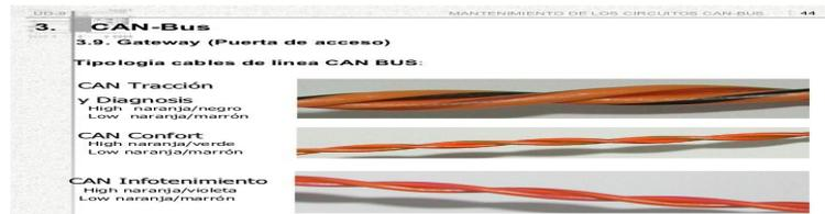
Fig. 2. Cable típico CAN-BUS.
