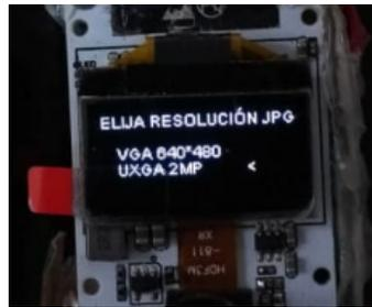
Fig. 8. Selección de resolución de fotografía; VGA o 2MP.
