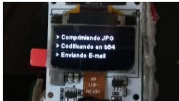
**Fig. 13.** Si el botón es presionado, se captura la imagen e inicia el proceso de envío.
