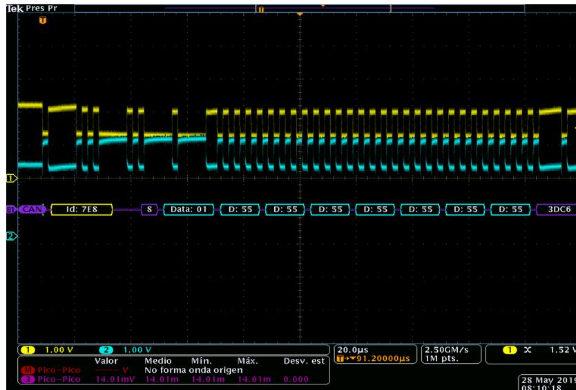
Fig. 14. Fragmento de trama enviada, donde el primero dato es 0x01, siendo este, el que procesa y representa el PIC en los leds.
