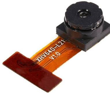
**Fig. 4.** Cámara OV2640 de 2Mp controlada por protocolo I2C.
